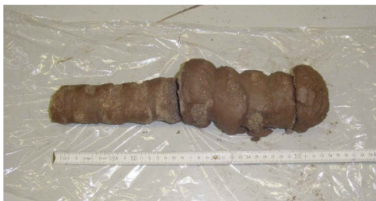
Figura 10. Formación de columnas de grava.
